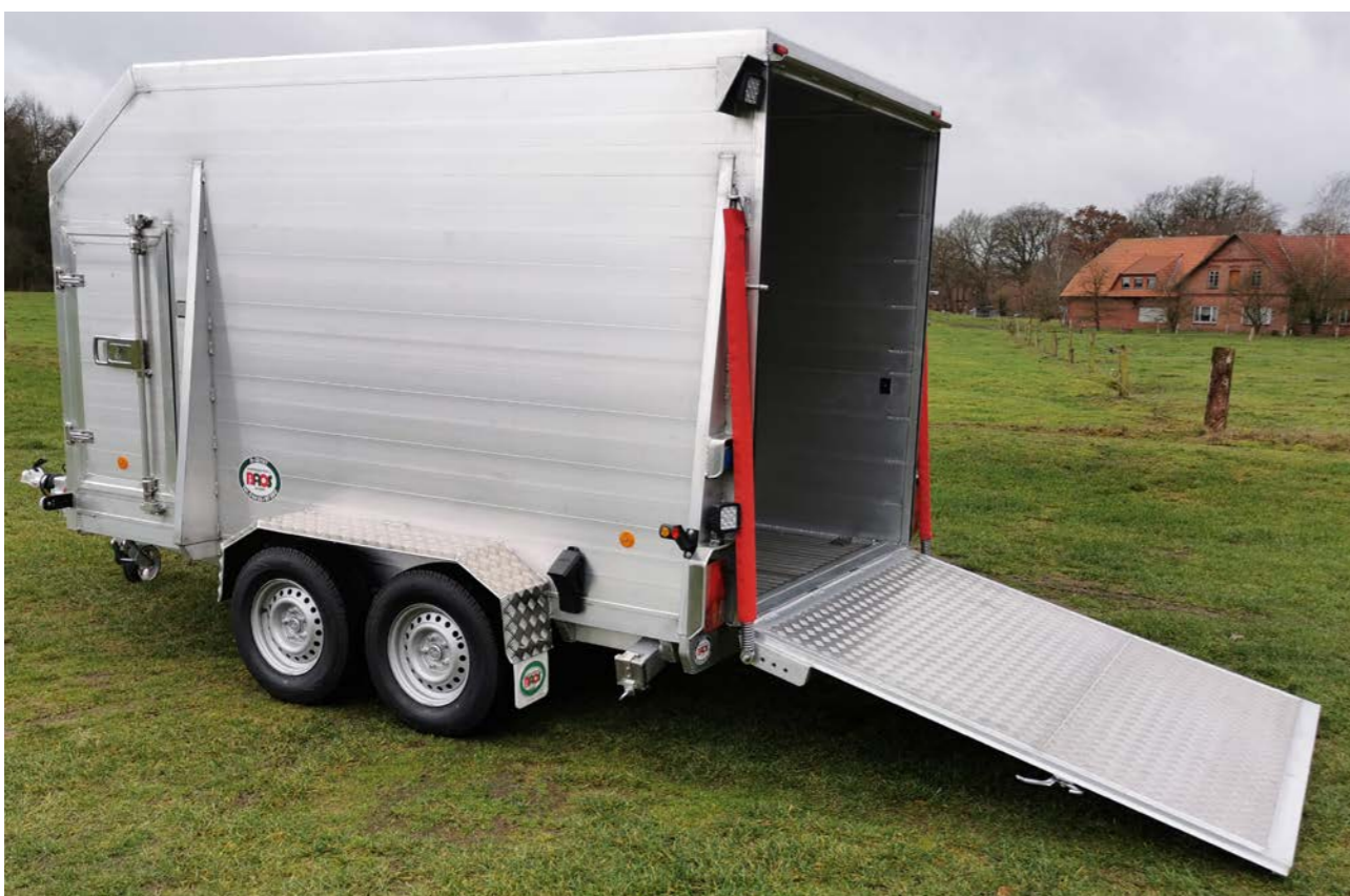
Der BAOS-Anhänger ist komplett aus Aluminium verschweisst, mit einer Seilwinde und einer ausreichend dimensionierten Blutwanne ausgestattet. Bild: BAOS Anhängerbau GmbH
