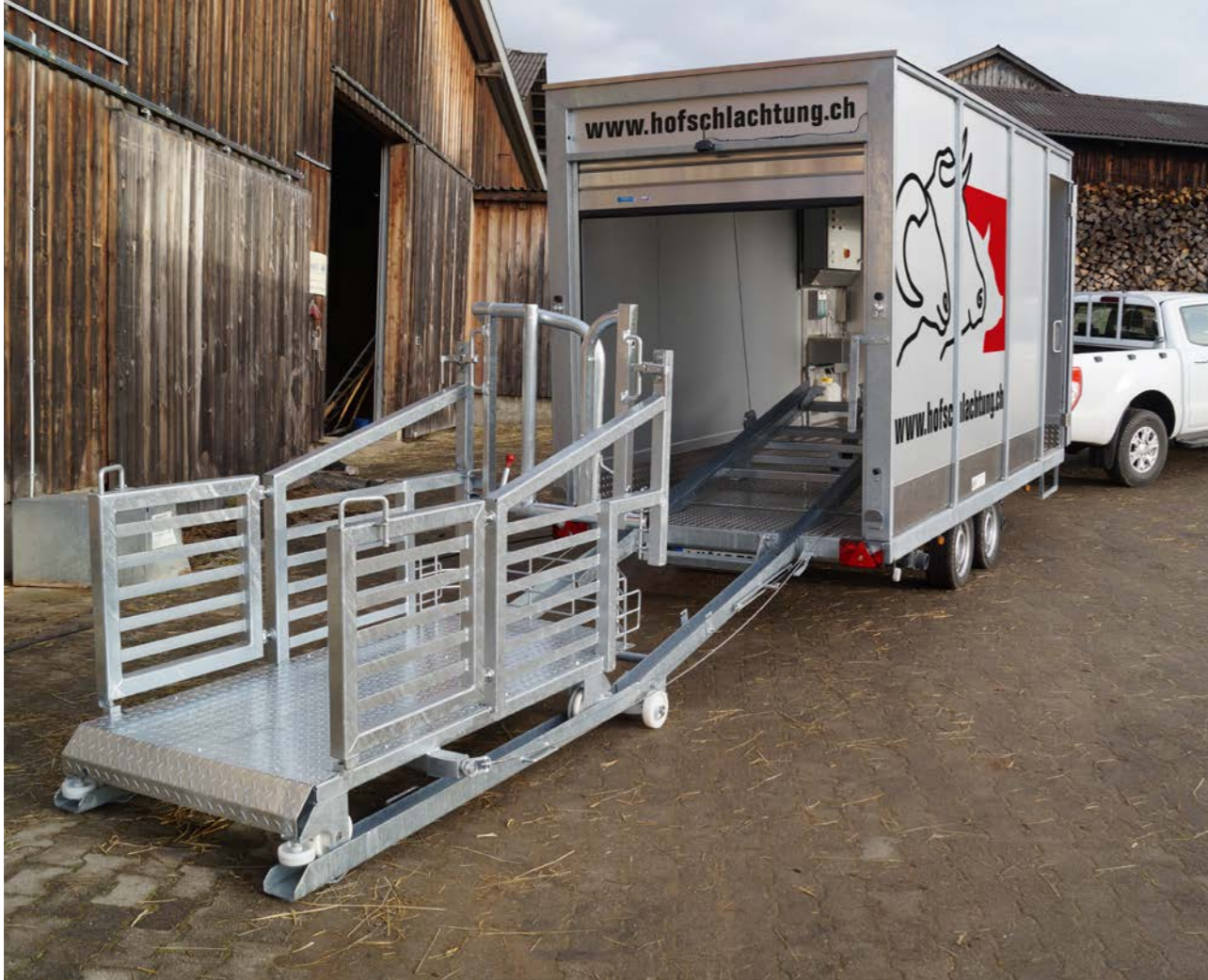
Mischa Hofer von «Platzhirsch Hofschlachtungen GmbH» möchte mit einer «mobilen Schlachteinheit» arbeiten. Das Tier wird im integrierten Fressgitter betäubt, ins Fahrzeuginnere gezogen und dort entblutet. Bild: Mischa Hofer
